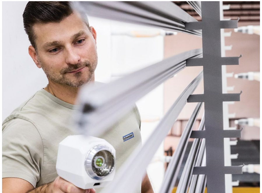
Das Handgerät von Winterthur Instruments dient KMUs dazu, die Dicke der Beschichtung während des Prozesses zu messen und so grosse Mengen an Material und Energie zu sparen. (Bild: Stefan Kubli)
