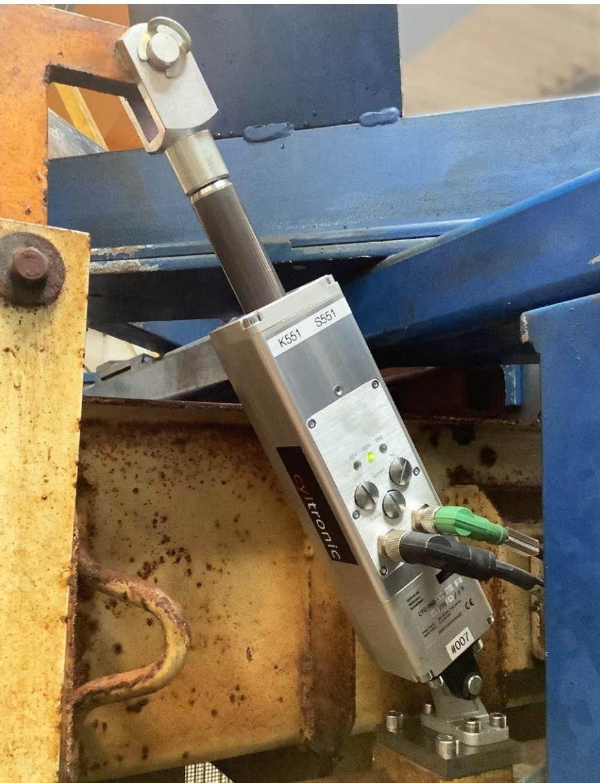
Elektrozyylinder sind sehr viel energieeffizienter als Pneumatikzylinder. Beim Motorsägenhersteller Stihl Kettenwerk in Wil SG kommen Elektrozyylinder von Cyltronic zum Einsatz.
